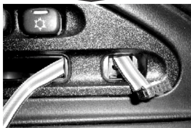
Рис. 2. Порядок укладки шлейфа.
