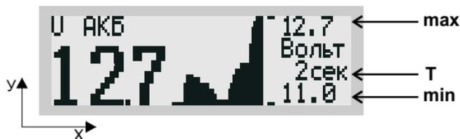
В режиме графопостроителя на дисплей выводится мгновенное значение параметра и график 39 отсчетов поведения параметра с интервалом временных отсчетов "Т", устанавливаемым из Группы 6 Дисплея Установок 1 (1-99 секунд). Самый правый отсчет на графике соответствует текущему.
