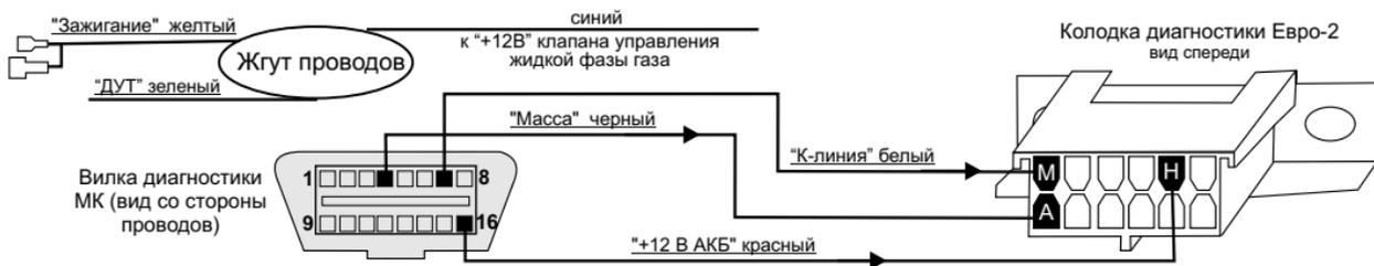
1. Выньте белый(к-линия) провод из 7-го контакта вилки диагностики МК и методом скрутки соедините с клеммой "М" колодки а/м Евро-2.
