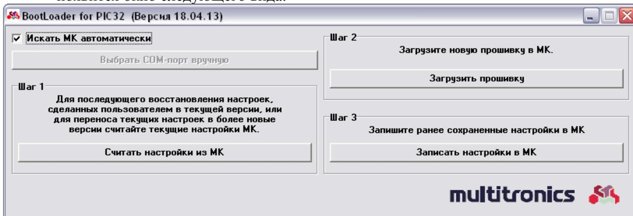
3.2. При выбранном пункте «Искать МК автоматически» программа обновления будет искать подключенный БК автоматически. Для ручного указания используемого порта необходимо снять отметку данного пункта, нажать кнопку «Выбрать СОМ порт вручную» и выбрать порт, используемый БК.
