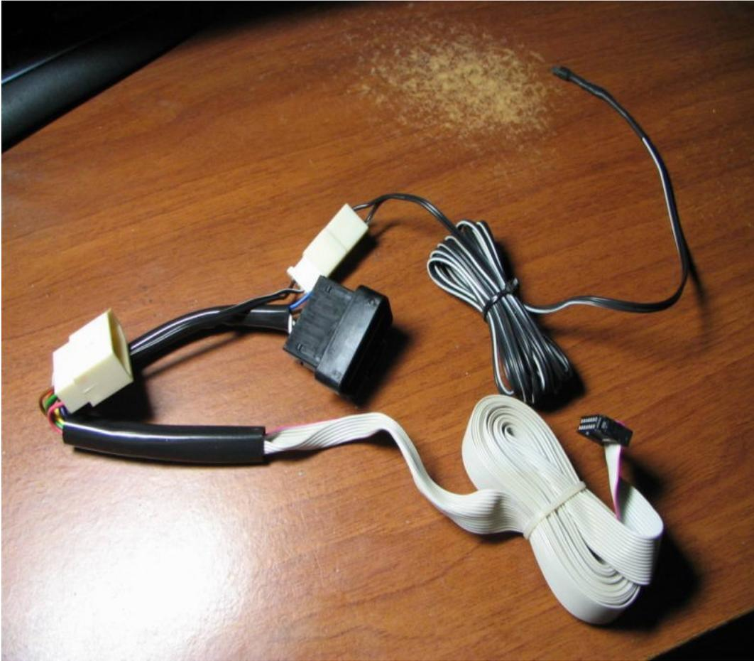
Кабель. Лента стала шире, что логично Также в комплекте кладется фишка для подключения к автомобилюИ что удобно. в общем случае в случае Лачети, достаточно подключить фишку к колодке диагностики можно больше ничего не подключать
