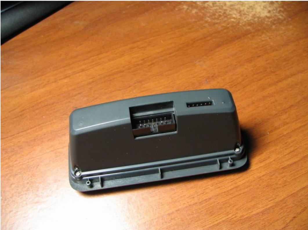
Вот и отличия: Разъем стал 14контактным, и второй разъем попрос на контакт. Дело в том, что этот комп, кроме К линии поддерживает CAN, L линию и еще какие-то протоколы диагностики. Еще на разъеме появилось подключение к сигналу габаритов.
