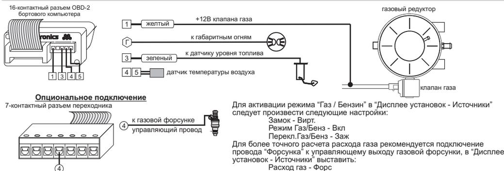
**Внимание!** При данном способе подключения возможно использование только виртуального замка зажигания:
