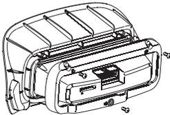
1. Собрать основной модуль МК с передней вставкой корпуса, для чего: вставить модуль во вставку, установить прижимную рамку и привинтить тремя винтами.
