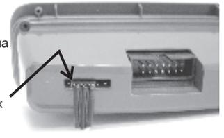
При подключении 2-х парковочных радаров одновременно (спереди и сзади) шлейфы соединяются параллельно (провод к проводу). Допускается одновременное подключение парктроников только одной модели, например совместная работа PT-4TC и PU-4TC невозможна.
