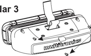
3. Провести интерфейсный шлейф (опционально шлейф парктроника) через окно в пластине узла крепления и через окно в корпусе МК, и вставить разъем в блок МК.
