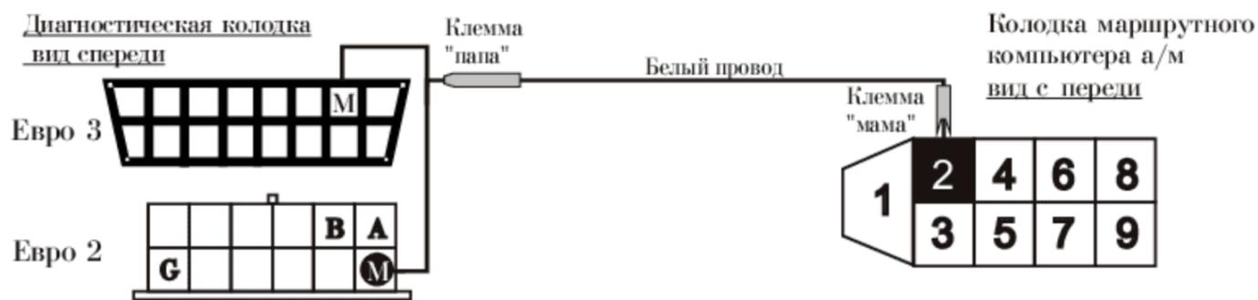
Противоположный конец этого провода - клемму "мама" вставьте в гнездо "2" колодки маршрутного компьютера а/м.
