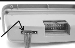
При подключении 2-х парковочных радаров одновременно (спереди и сзади) шлейфы соединяются параллельно (провод к проводу). Допускается одновременное подключение парктроников только одной модели, например совместная работа PT-4TC и PU-4TC невозможна.
