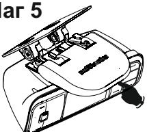
6. Определить место крепления МК на лобовом стекле или на "торпедо". При выборе места приклейки МК учитывайте возможность доступа к обоим винтам M4 поворотного крепления (см. п. 5) для обеспечения возможности демонтажа. Отрегулировать продольный и поперечный наклон корпуса, так чтобы экран был направлен на водителя, затем затянуть все крепления.
