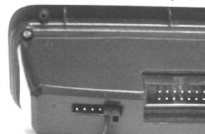
Провод "Габариты / Газ" подключается к 5 контакту дополнительного 6-контактного разъема компьютера, считая слева. Порядок подключения:
