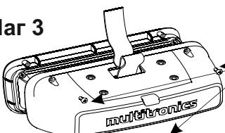
3. Провести интерфейсный шлейф (оциально) через окно в пластине узла крепления и через окно в корпусе МК, и вставить разъём в блок МК.
