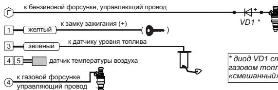
\* диод VD1 ставится при отсутствии показаний работы только на газовом топливе (показывается только режим работы «бензин» или «смешанный», без режима «газ»).
