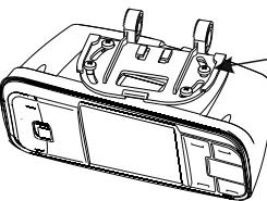
2. Наживить четырьмя саморезами собранный МК к пластине поворотного узла крепления.
