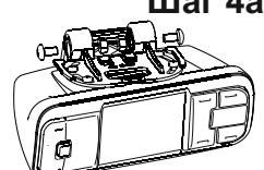
5а. Наживить двумя винтами с гайками основание поворотного узла к кронштейну крепления на "торпедо".
