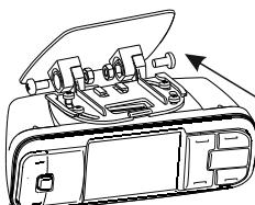
5. Наживить двумя винтами с гайками основание поворотного узла крепления к пятке узла крепления.
