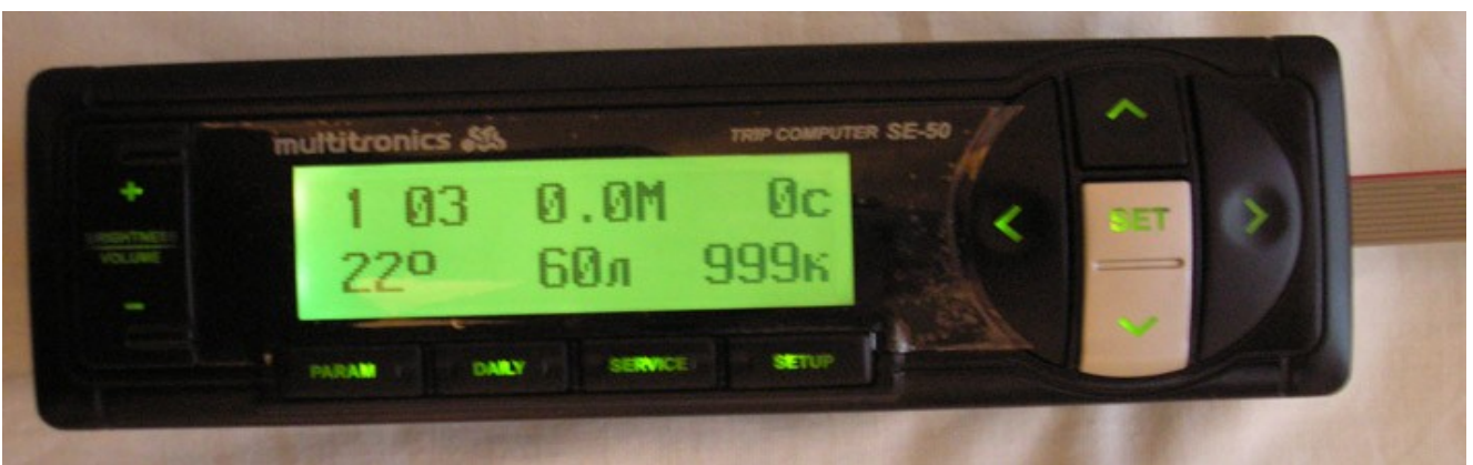
Фото 18 - Так как прибор не непосредственно для Лаши подсветка кнопок у него противно-оранжевая и цвет не меняет. Произвольно меняется лишь цвет дисплея. Приговор - перепаял светодиоды на зеленые. После всех вышеописанных операций совсем другой вид.
