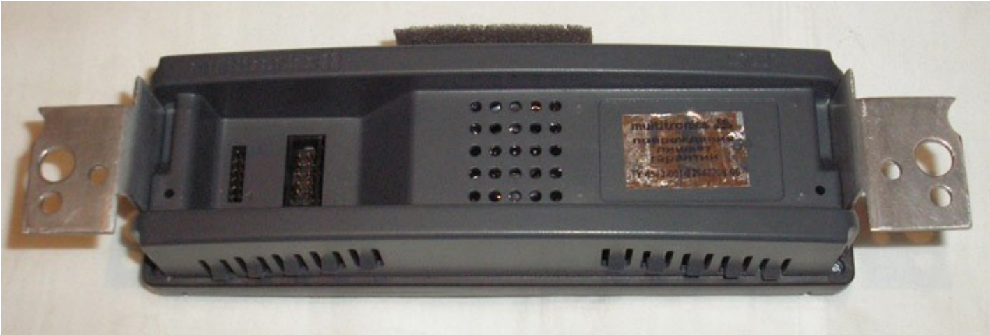
Фото 19,20,21 - Прибор с изготовленными кронштейнами и готовый к окончательной установке.
