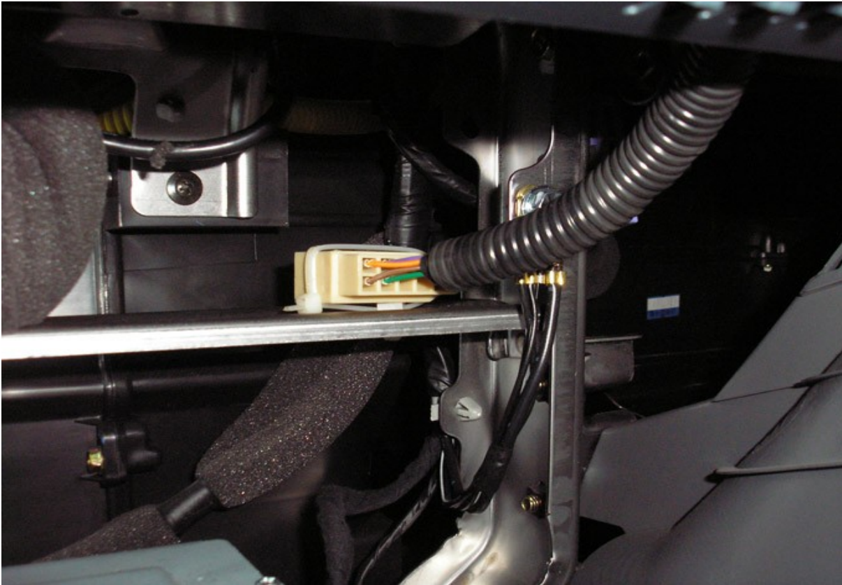
Фото 25 - Колодку разъема прикрепил к рамке в панели стяжкой - не болтается, симпатично и позволяет оперативно расстыковать при необходимости.
