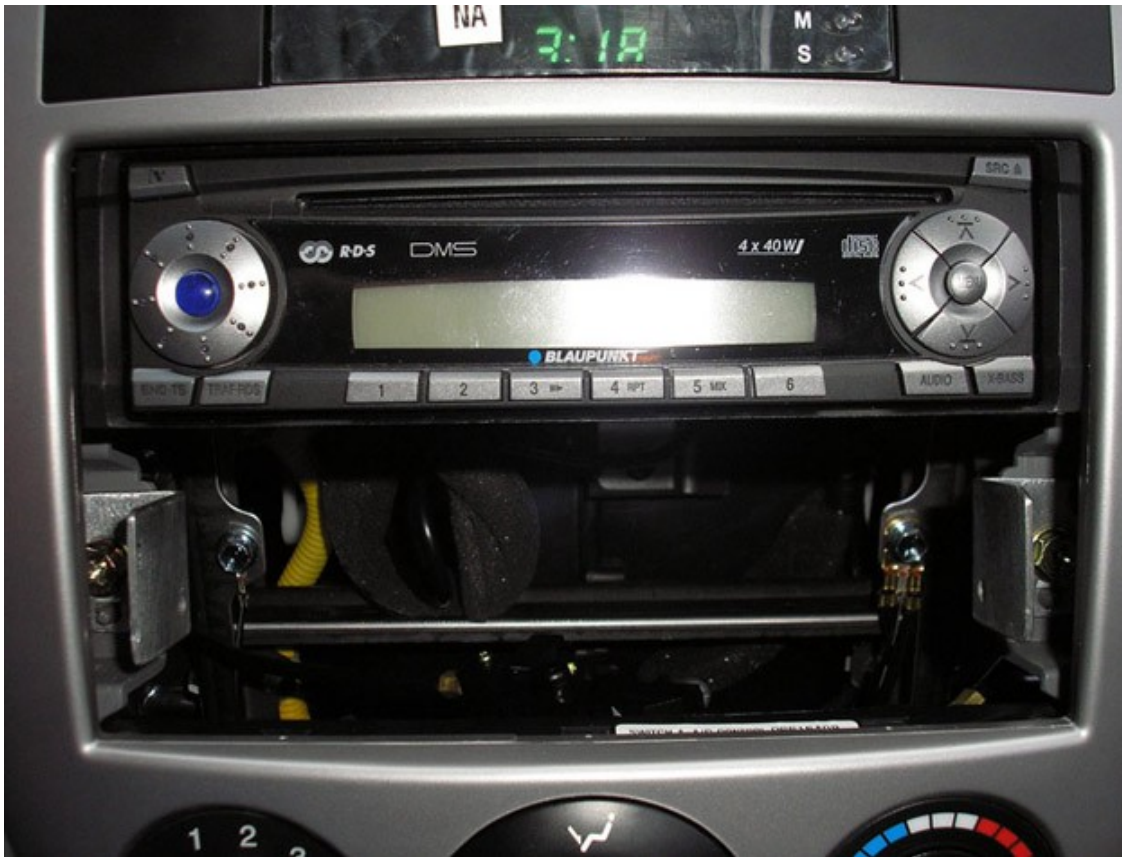
Фото 13 - Видны самодельные кронштейны крепления SE-50(немного забежал вперед:). Кстати, по этой фотке видно, что при необходимости поездки в сервис снять комп с кронштейнов-направляющих - дело минутное.
