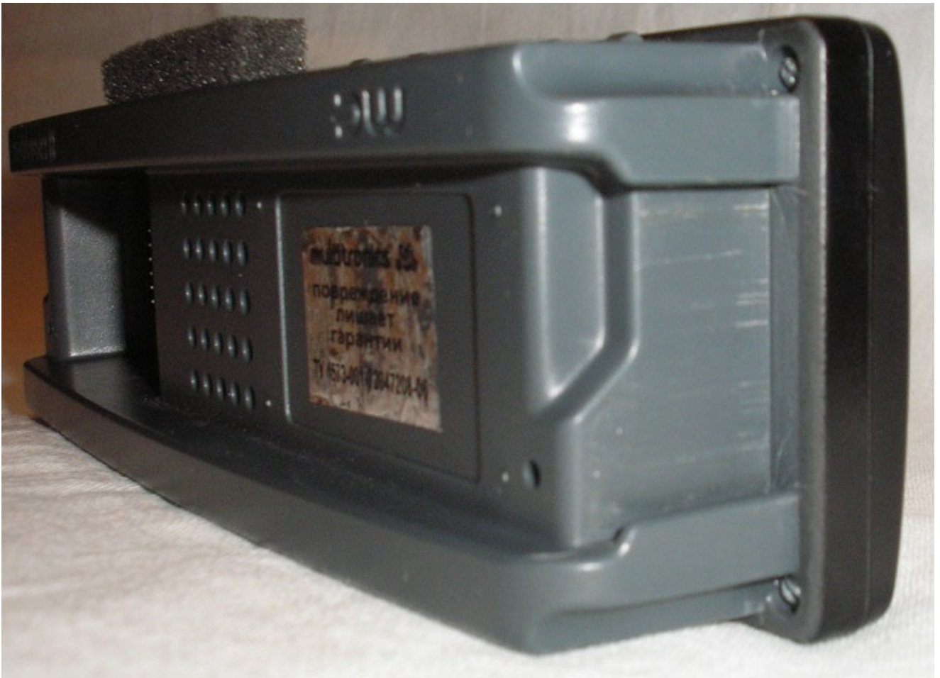
Фото 23 - Паза в корпусе прибора которыми мы и воспользовались и которые позволяют вытаскивать прибор при необходимости.
