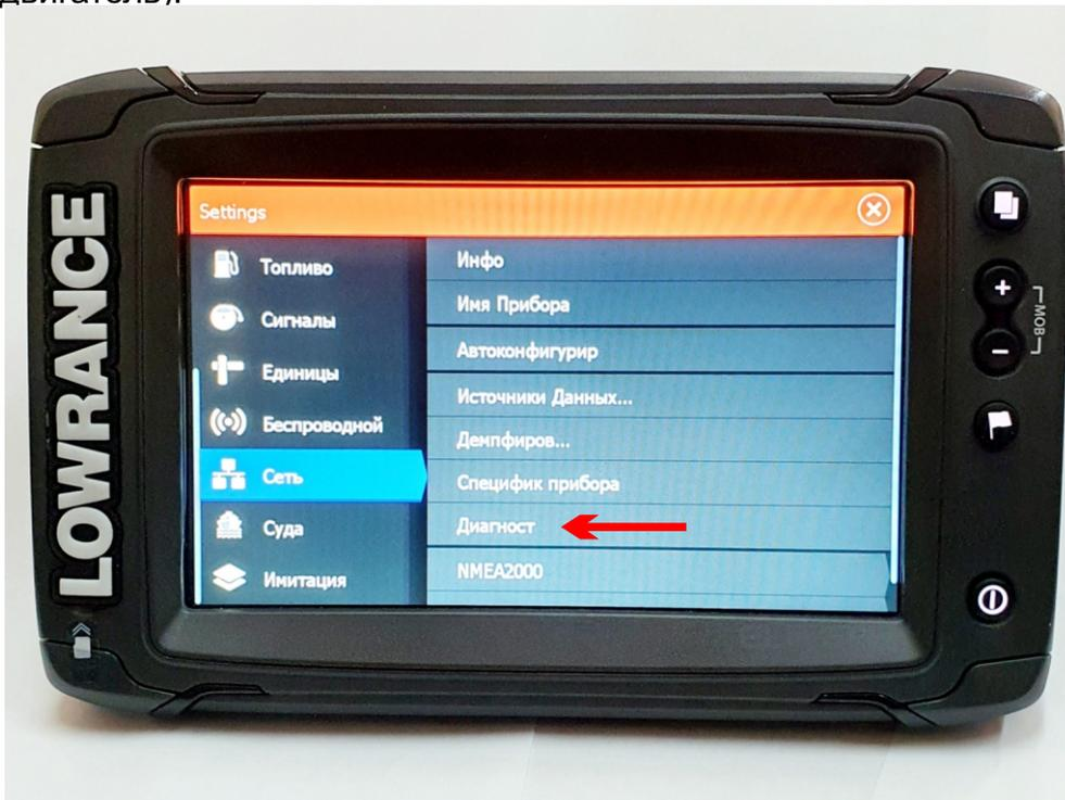
Если все было сделано правильно, на экране будут выведены сведения о работающей сети (Состояние шины - Bus On) и цифры загруженности линии передачи данных (RX, TX Сообщения, Загрузка шины).
