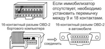
Если в машине присутствует диагностический разъем Евро-2, подключение К-линии производить по следующей схеме
